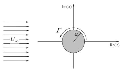
4.9 Se tiene un cilindro infinito de radio a con circulación atrapada  $\Gamma$ , inmerso en un fluido incompresible e irrotacional de densidad  $\rho$ . A una distancia 2a se encuentra un dipolo de intensidad  $\mu_0$ , orientado según se muestra en el siguiente gráfico. Hallar el valor de  $\mu_0$  para que la fuerza sobre el cilindro sea nula.
