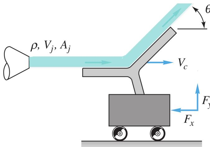
Un chorro de fluido incompresible de densidad uniforme  $\rho$  golpea un deflector ubicado sobre un carrito el cual se mueve hacia la derecha a una velocidad constante  $V_c$ . Luego de abandonar el deflector el chorro cambia su dirección en un ángulo  $\theta$ .
