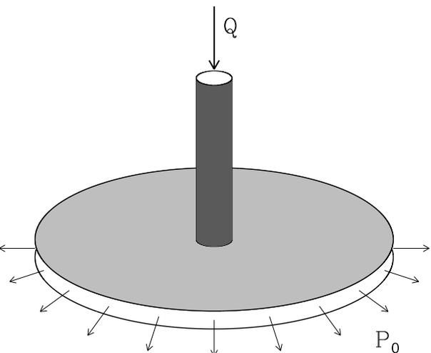
a) Escriba las tres componentes de la ecuación de Navier – Stokes para el flujo entre los discos (use coordenadas adecuadas para la simetría del problema).
