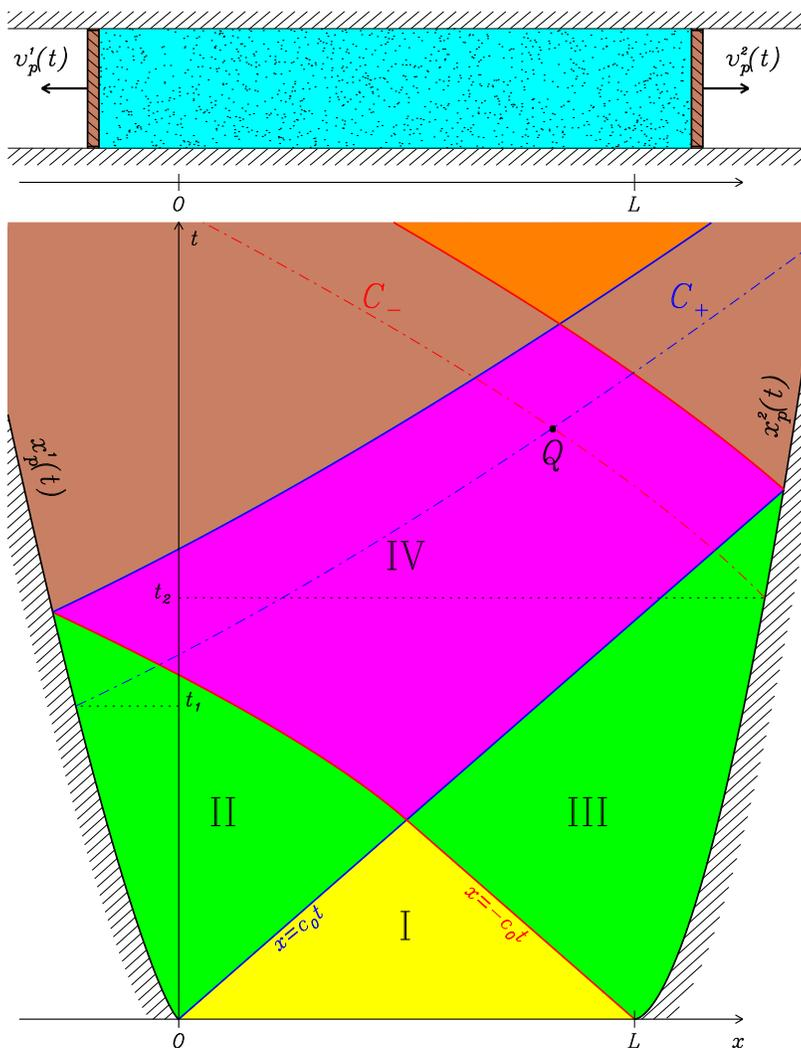
Se tiene un gas ideal entre dos pistones inicialmente separados una distancia  $L$  con estado inicial uniforme  $v = 0$  y  $\rho = \rho_0$ . A  $t = 0$  los pistones comienzan a extraerse con velocidades prescritas  $v_p^1(t)$  (pistón izquierdo) y  $v_p^2(t)$  (pistón derecho), como se indica en la parte superior de la figura. El estado del gas se esquematiza en el plano  $x - t$  en la parte inferior de la figura.
