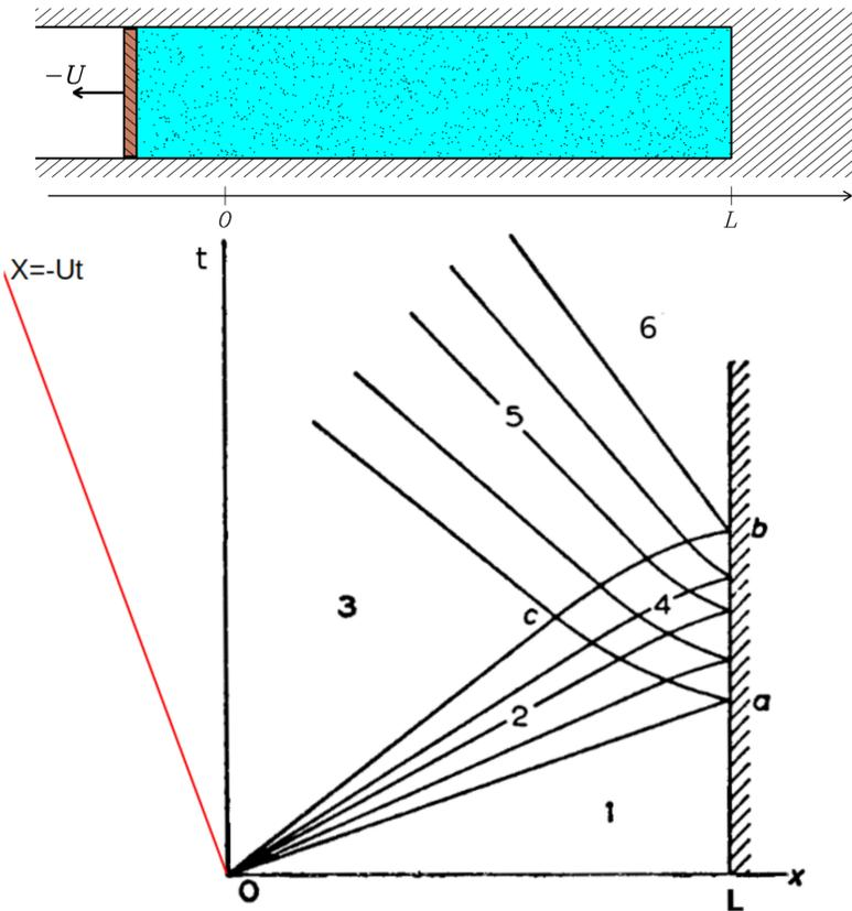
El gas inicialmente está en reposo y con densidad  $\rho_0$  y presión  $p_0$  uniformes. El estado del gas se esquematiza en el plano  $x - t$  en la parte inferior de la figura.
