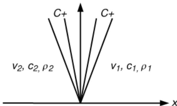
**Problema 3. Onda de rarefacción generada por el arranque de un pistón** Un gas ideal politrópico ( $p = A\rho^\gamma$ ) con densidad inicial  $\rho_0$ , está en reposo en un tubo infinito, cerrado en uno de sus extremos por un pistón. A  $t = 0$  el pistón comienza a moverse hacia afuera con velocidad  $-U$  constante.
