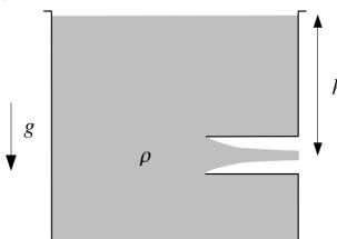
La embocadura penetra profundamente en el interior del tanque (este tipo de embocadura es la llamada de Borda). El tanque es lo suficientemente grande como para que pueda considerarse  $v\approx 0$  en la superficie libre. Como consecuencia, prácticamente tampoco se registra movimiento en las paredes laterales y entonces en esa zona la presión es la hidrostática. Se asume presión atmosférica en el exterior.
