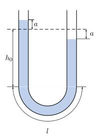
**Problema 10.** Se tiene un depósito móvil abierto superiormente con un líquido de densidad  $\rho$  en su interior el cual a t=0 tiene una profundidad  $h_0$ . El depósito se mueve hacia la izquierda a velocidad
