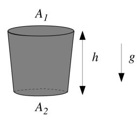
A t=0 se abre la tapa inferior dejándoselo fluir, mientras que al mismo tiempo se va agregando el mismo líquido por la tapa superior, de tal manera de mantener constante el nivel. Cuando la inclinación de las paredes respecto de la vertical es pequeña, se puede obtener una solución aproximada del problema despreciando las componentes horizontales de la velocidad. Suponga que la variación de la sección del embudo es lineal, de la forma  $A(z)=(1+\epsilon z/h)A_2$  ( $\epsilon\ll 1$ ).
