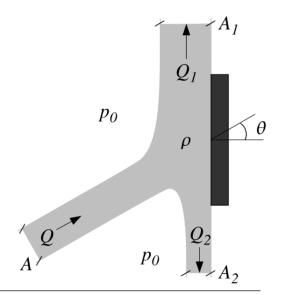
Problema 7. Tubería en codo Determine la fuerza que el líquido, considerado ideal, ejerce sobre una cañería muy extensa doblada en ángulo recto como se indica en la figura. Considere que la cañería se encuentra sobre una superficie horizontal. ¿Por qué se necesita la hipótesis de cañería muy extensa?
