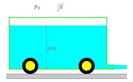
constante (existe fricción entre las ruedas y el suelo) y deja escapar líquido por un orificio de sección  $A_s \ll A$ , siendo A el área de la base del depósito.
