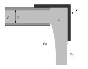
**Problema 5.** Si se interrumpe el extremo de un tubo muy largo con una tapa deslizante como se muestra en la figura, determine el caudal Q del líquido ideal e incompresible con los datos indicados, donde F es la fuerza horizontal que se aplica para evitar que deslice la tapa.
