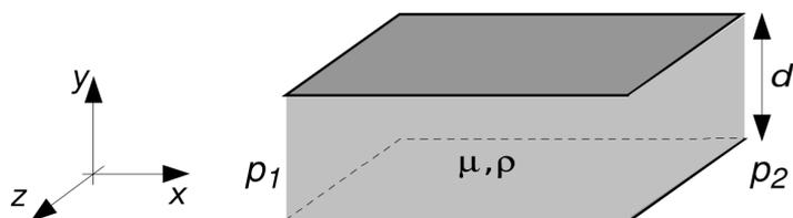
**Problema 12.** Resuelva el caso de un líquido entre dos planos en reposo de dimensiones infinitas, movido por un gradiente de presión oscilante en forma armónica en el tiempo, del tipo  $\Delta p = p_2 - p_1 = p_0 \cos(\omega t)$ . Utilice análisis dimensional para obtener la dependencia funcional del caudal medio  $\langle Q \rangle$  (en un semi-período) que se establece a través de una sección transversal al movimiento.
