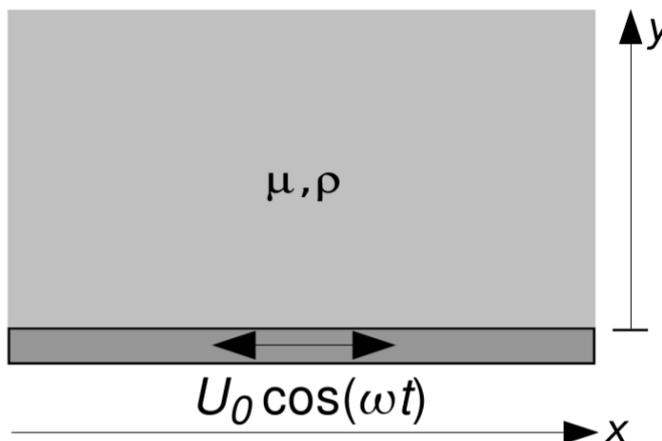
**Problema 11.** Un fluido muy viscoso, con viscosidad dinámica  $\mu$  y densidad  $\rho$ , se encuentra entre dos planos de dimensiones infinitas. El plano inferior está en reposo mientras que el plano superior, a una distancia  $d$ , se mueve con un movimiento armónico con velocidad  $U_0 \cos(\omega t)$ .
