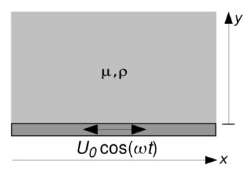
**Problema 11.** Un fluido muy viscoso, con viscosidad dinámica  $\mu$  y densidad  $\rho$ , se encuentra entre dos planos de dimensiones infinitas. El plano inferior está en reposo mientras que el plano superior, a una distancia d, se mueve con un movimiento armónico con velocidad  $U_0 \cos(\omega t)$ .
