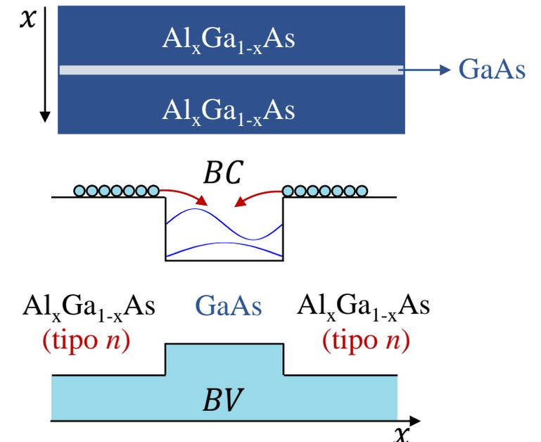
Utilizando  $Al_xGa_{1-x}As$  tipo  $n(p)$ ,  $e^- (h^+)$  "caen" al pozo creando un gas bidimensional de  $e^- (h^+)$ .
