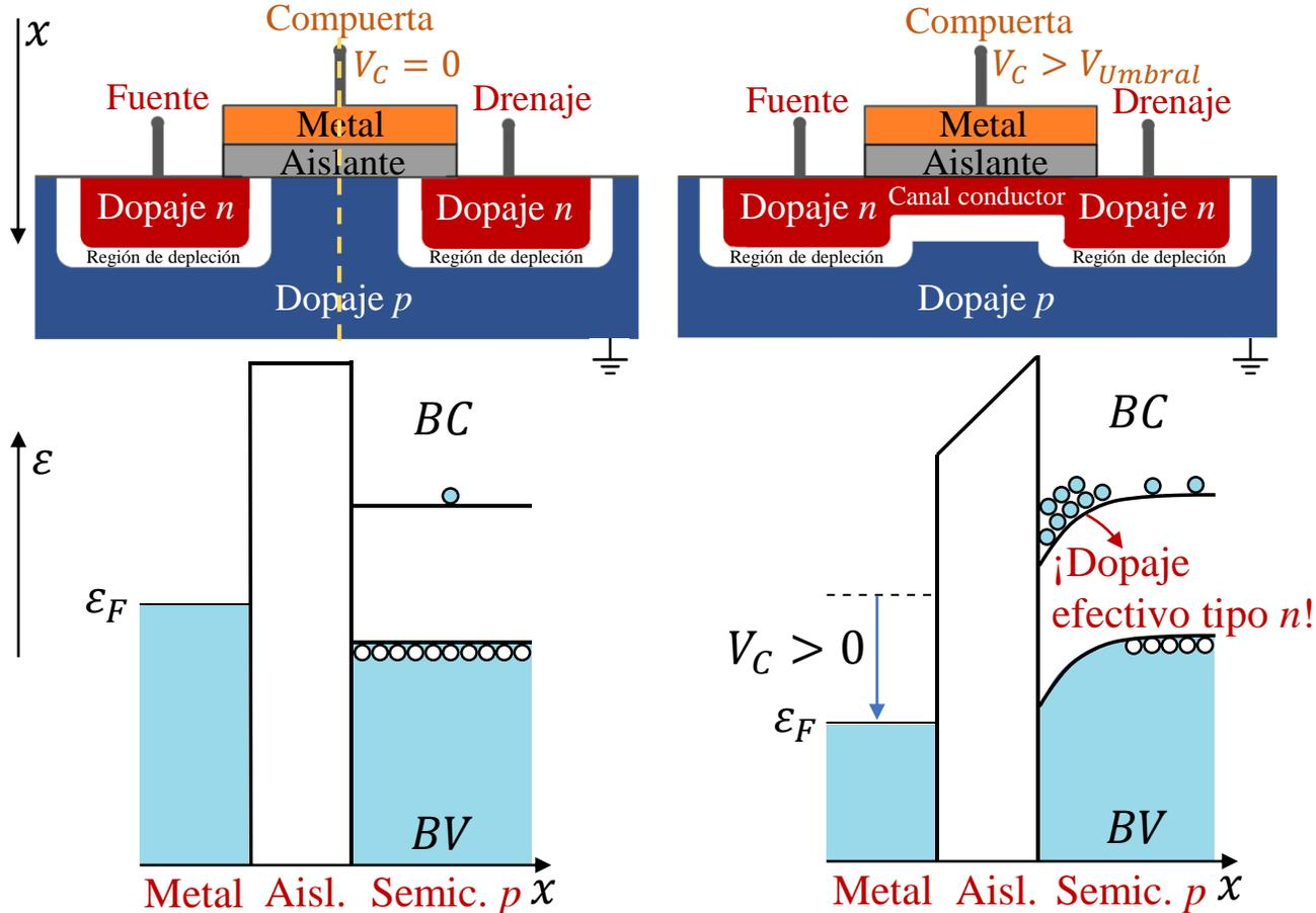
Al aumentar  $V_C$  por encima de  $V_{umbral}$ , se crea un canal de conducción, cuyo tamaño (y resistencia) depende de  $V_C$ .
