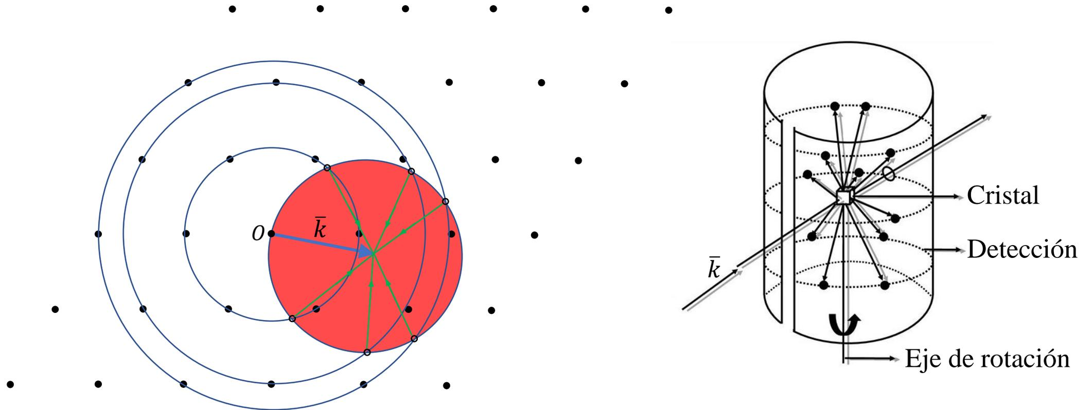
Se producen reflexiones de Bragg cuando puntos de la RR intersecan la superficie de la esfera.
