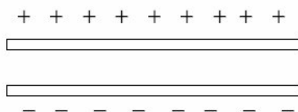
Fig. 4: Esquema de capacitor de placas paralelas.
