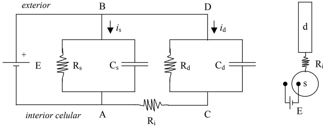
**Datos:**  $C_s = 5 \text{ nF}$  ;  $C_d = 1 \text{ nF}$  ;  $R_s = 1 \text{ G}\Omega$  ;  $R_d = 12 \text{ G}\Omega$  ;  $R_i = 1 \text{ G}\Omega$  ;  $E = 100 \text{ mV}$  (negativo en el interior). ( $n: 10^{-9}$  ;  $G: 10^6$  ;  $m: 10^{-3}$ )
