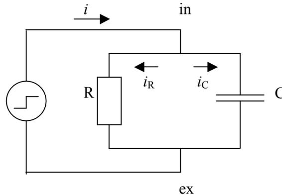
El circuito de la figura reproduce el comportamiento eléctrico de la membrana celular (dejando de lado la generación de potencial de acción). El capacitor, que representa la capacidad de la membrana lipídica, se encuentra en paralelo con una resistencia que representa a los canales iónicos. El dispositivo de la izquierda es una fuente de corriente y permite fijar la corriente total ( $i$ ) que circula entre el interior (in) y el exterior (ex) de la célula.
