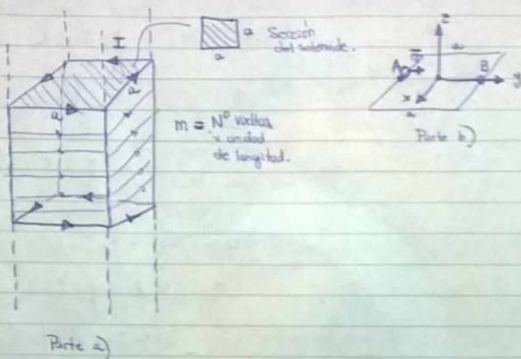
Se tiene un solenoide <sup>infinito</sup> de sección transversal cuadrada de lado  $a$ , el cual está formado por un enrollamiento de densidad  $m$  ( $n^{\circ}$  vueltas/m) y transporta una corriente  $I$ .
