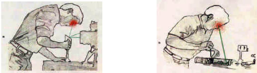
Fig. 1 :a) Daño retinal resultante de exposición directa a un haz secundario. b) Daño retinal resultante de la exposición del ojo a un “ débil” haz secundario proveniente de una ventana en ángulo de Brewster.
