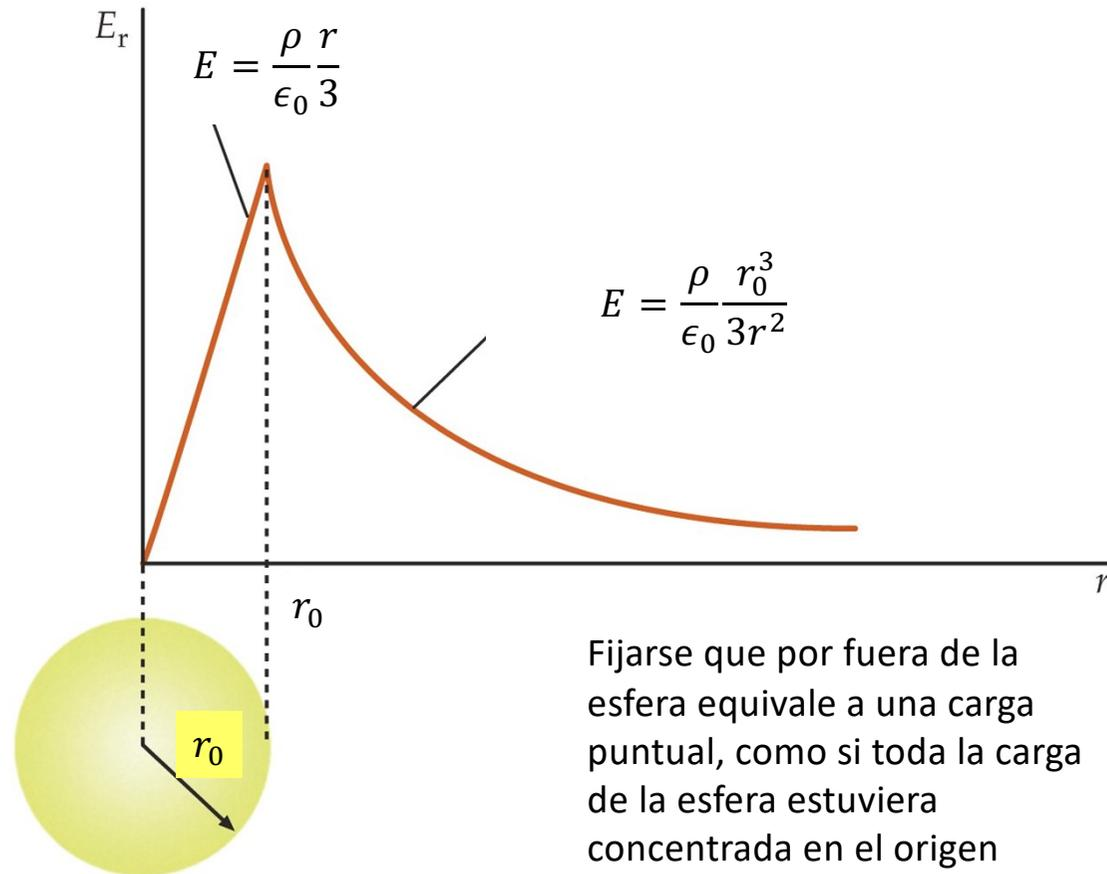
Fijarse que por fuera de la esfera equivale a una carga puntual, como si toda la carga de la esfera estuviera concentrada en el origen
