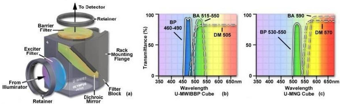
**Figura 2.** (a) Cubo de filtros de un Microscopio de Fluorescencia. (b) Espectros de los filtros que conforman el cubo U-MWIBBP: excitación BP 460-490, emisión BA 515-550 y dicroico DM 505. (c) Espectros de los filtros del cubo U-MNG: excitación BP 530-550, emisión BA 590 y dicroico DM 570. Modificado de Davison M, Abramowitz M, *Fluorescence Filters*. Olympus Microscopy Resource Center.
