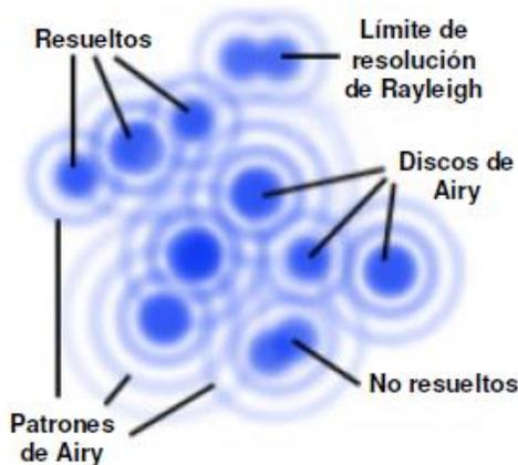
**Figura 5. Resolución.** Esquema de una imagen de partículas de tamaño sub-resolución. Se observan los patrones de difracción de Airy proveniente de cada una de las partículas en caso de que su distancia sea mayor a la resolución lateral. Tomado de <sup>2</sup>.
