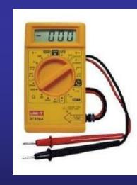
En la actualidad, amperímetro y voltímetro vienen integrados en un único instrumento llamado **multímetro**. Tienen además otras funciones, entre las que se destaca el óhmetro, que mide valores de resistencias
