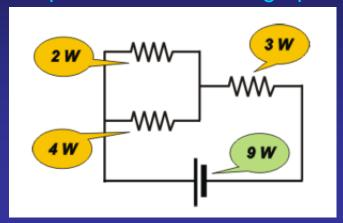
Las fuentes, pilas o baterías si estan conectadas correctamente entregan energía, el resto de los elementos, disipan toda la energía en su totalidad (aunque parte de la energía se "pierda" como calor). El kilowatt-hora, kWh, es una unidad de energía, no de potencia. Tiene un nombre engañoso, se trata del producto entre dos unidades: kilowatt y hora. La primera es indudablemente de potencia, mil watts; y la segunda de tiempo. El producto de potencia por tiempo, da energía.
