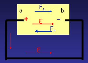
Formemos ahora un circuito completo conectando un alambre de resistencia R a los bornes de la fuente. La diferencia de potencial entre los bornes establece un campo eléctrico adentro del alambre que provoca un flujo de corriente de a hacia b de mayor a menor potencial.
