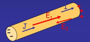
En consecuencia, se acumula una carga positiva neta en un extremo y una carga negativa en el otro. Estas cargas crean pos sí mismas un campo eléctrico  $E_2$  en dirección opuesta a  $E_1$ , lo cual hace disminuir el campo eléctrico total y por tanto la densidad de corriente.
