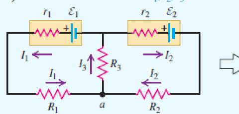
**b)** La aplicación de la regla de los nodos al punto a elimina  $I_3$ .
