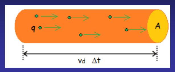
Si por un alambre conductor circulan *n* cargas *q* por unidad de volumen, la intensidad de corriente vendrá dada por:
