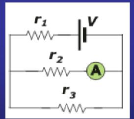
Para que no afecte la circulación de corriente ni las caídas de voltaje, el amperímetro ideal es aquel de resistencia nula (RA = 0). Como esto no es posible en la práctica, se buscan para su elaboración materiales de resistencia despreciable respecto a las del circuito
