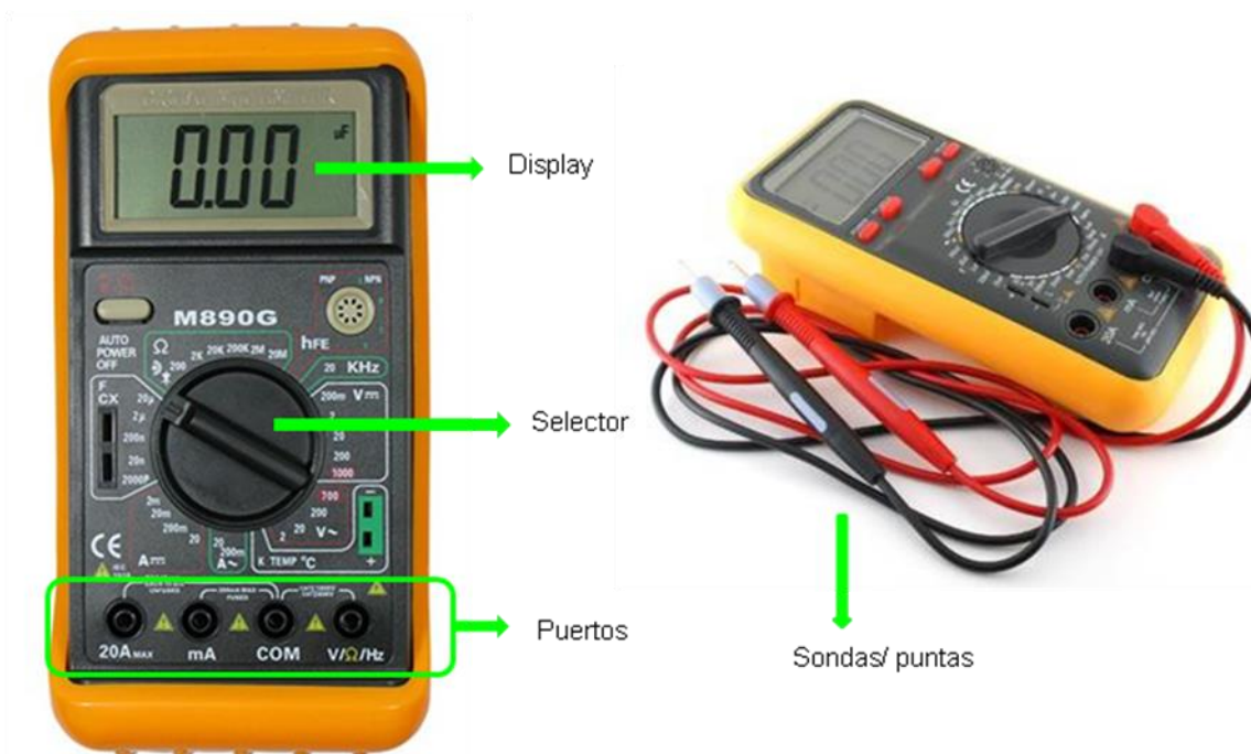
Figura 1: ejemplo de multímetro digital y sus componentes.
