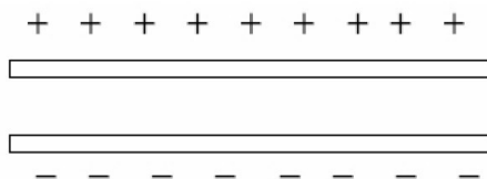
Figura 1: Esquema de un capacitor de placas paralelas.
