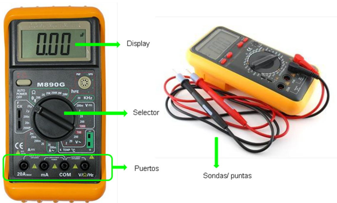
Figura 1: ejemplo de multímetro digital y sus componentes.
