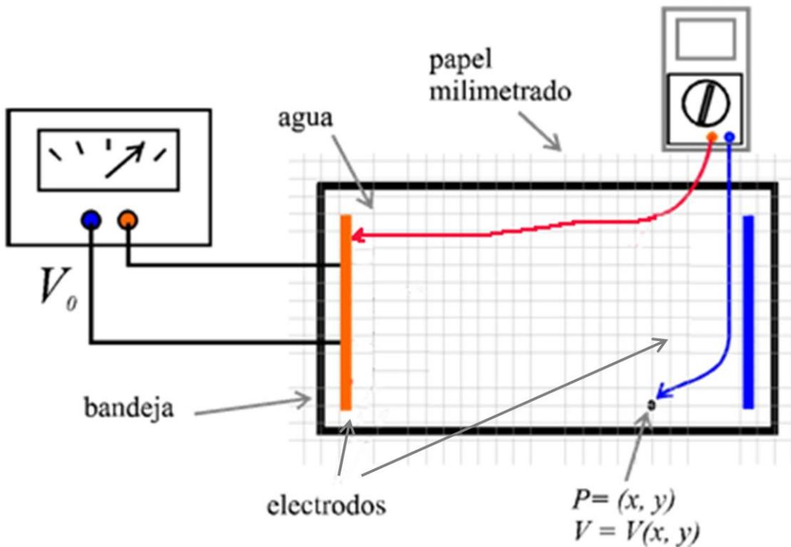
**Figura 1 Experimento de laboratorio.** La bandeja de material aislante contiene agua. Las líneas gruesas continuas representan los electrodos metálicos. En el punto de coordenadas  $(x,y)$ , se mide el valor del potencial eléctrico  $V(x,y)$ .
