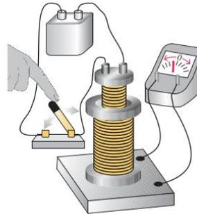
El campo  $\mathbf{B}$  generado por la **bobina primaria** atraviesa la **bobina secundaria**.
