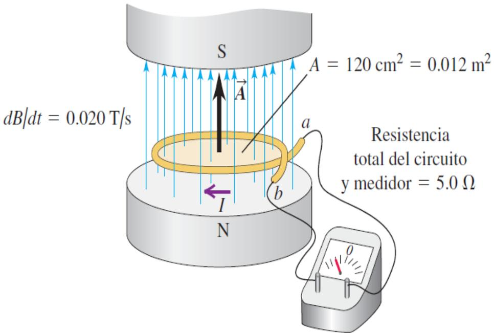
El campo magnético entre los polos del electroimán es uniforme en cualquier momento, pero su magnitud se incrementa a razón de 0.02 T/s. El área de la espira conductora en el campo es de 120 cm<sup>2</sup>, y la resistencia total del circuito, incluyendo el medidor, es de 5 Ω.
