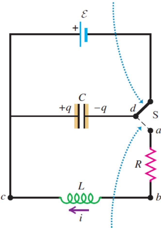
Cuando el interruptor S pasa a esta posición, el capacitor se descarga a través del resistor y el inductor.
