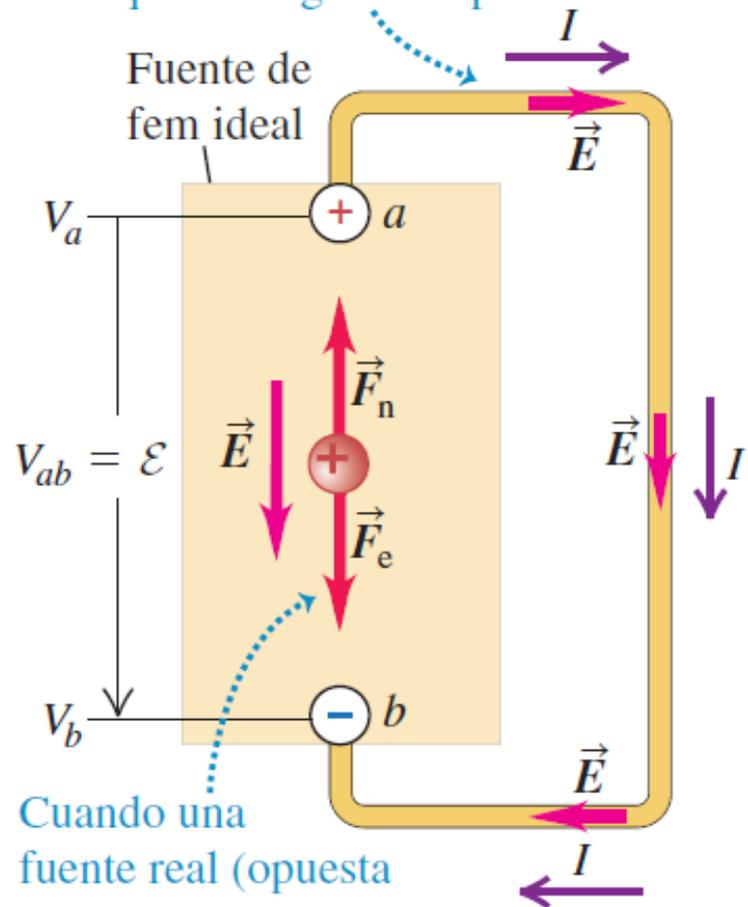
Cuando una fuente real (opuesta a la ideal) de fem se conecta a un circuito, disminuye,  $V_{ab}$  y por lo tanto  $F_e$ , de manera que,  $F_n > F_e$  y  $\vec{F}_n$  realiza un trabajo sobre las cargas.
