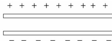
Figura 1: Esquema de un capacitor de placas paralelas.
