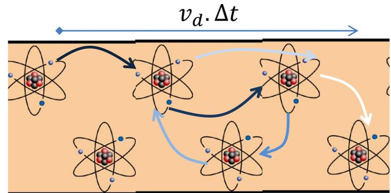
Nota:  $v_d \sim 0.01 \frac{mm}{s}$  (muy pequeño!...un electrón en particular tarda 8 horas en atravesar un cable de un metro!)
