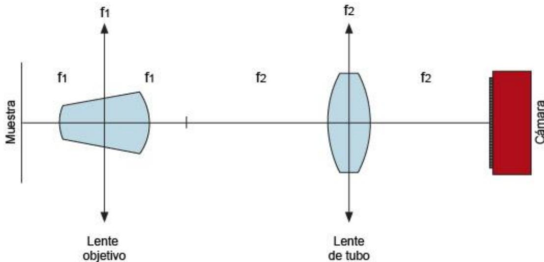
16. Calcule la magnificación de este sistema de dos lentes. ¿Cómo deberá ser la distancia focal del objetivo comparado con la de la lente de tubo para lograr magnificar nuestra imagen? ¿La imagen es derecha o invertida? Nivel difícil: Realice el trazado de rayos del sistema.
