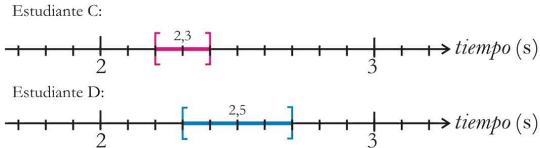
Figura 2: Dos medidas del período de un péndulo. La discrepancia es de 0,2s y en este caso es *no es significativa* porque los intervalos de las mediciones se solapan.
