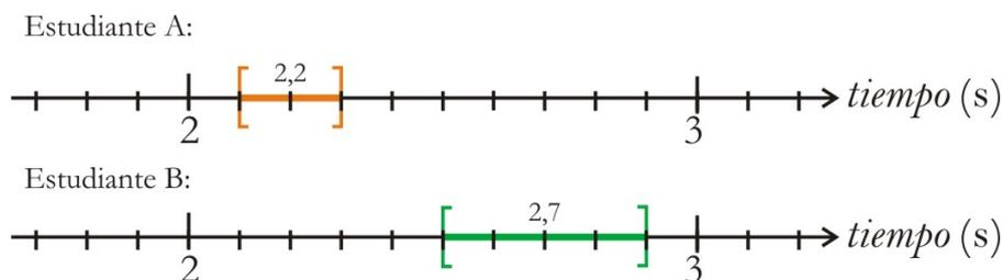
Figura 1: Dos medidas del período de un péndulo. La discrepancia (diferencia entre las dos mejores estimaciones) es de 0,5 s y es significativa porque es mucho mayor que el error combinado en las dos mediciones.
