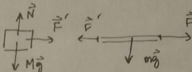
3. Ecuaciones de Newton para  $x_b$  (coord. x del bloque) y  $x_s$  (coord. x de la soga)
