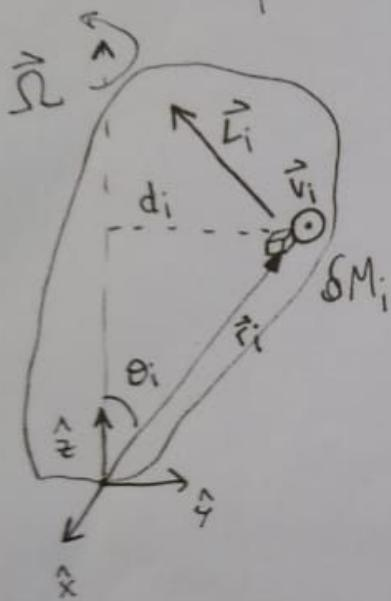
$$d_i = r_i \sin \theta_i = \text{distancia entre } \vec{r}_i \text{ y el eje de rotación.}$$
