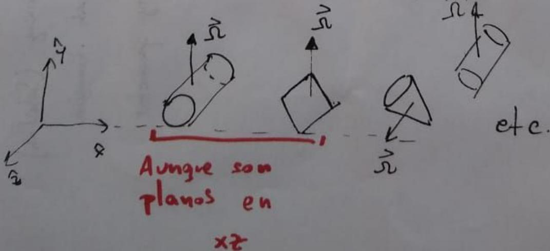
obs. Es posible cambiar el eje de rotación por uno paralelo anterior modificando únicamente la velocidad de traslación
