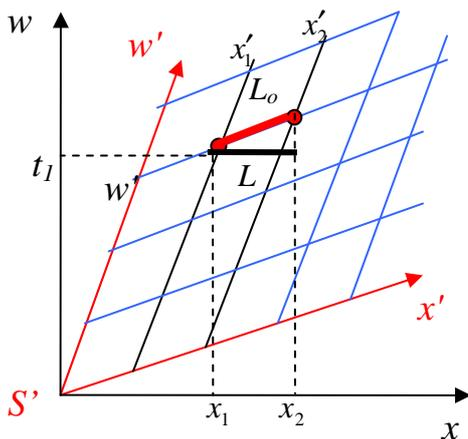
La varilla está en reposo en el sistema  $S'$ . Su longitud en reposo es  $L_o = x'_2 - x'_1$  (independiente de  $t'$ ). Como las mediciones de los extremos de la varilla en  $S$  tienen que hacerse **simultáneamente en  $S$** , la longitud que se mide,  $L = x_2 - x_1$ , resulta contraída respecto de  $L_o$ . Obviamente, lo mismo sucede si intercambiamos  $S$  y  $S'$ .
