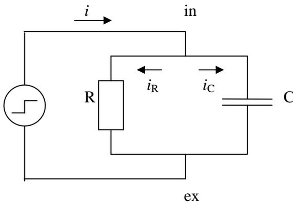
se encuentra en paralelo con una resistencia que representa a los canales iónicos. El dispositivo de la izquierda es una fuente de corriente y permite fijar la corriente total que circula entre el interior (in) y el exterior (ex) de la célula.
