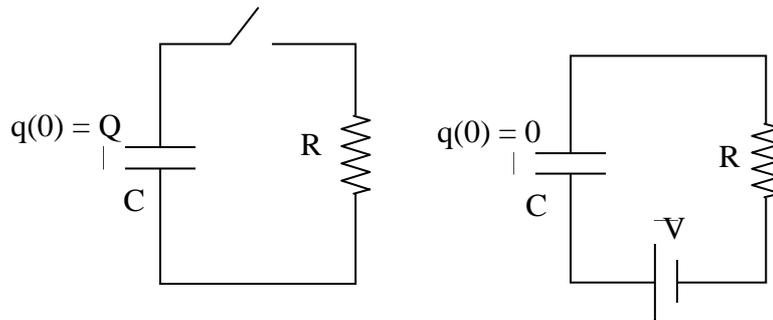
13. El circuito de la figura reproduce el comportamiento eléctrico de la membrana celular. El capacitor, que representa la capacidad de la membrana lipídica,
