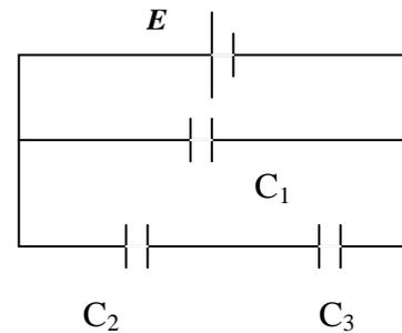
Datos:  $C_1=6 \mu\text{F}$ ,  $C_2=20 \mu\text{F}$ ,  $C_3=5 \mu\text{F}$ ,  $E=120 \text{ V}$
