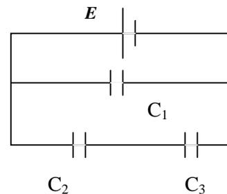
Datos:  $C_1=6 \mu\text{F}$ ,  $C_2=20 \mu\text{F}$ ,  $C_3=5 \mu\text{F}$ ,  $E=120 \text{ V}$
