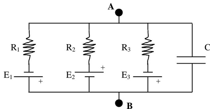
Datos:  $E_1 = 80 \text{ mV}$ ;  $E_2 = 50 \text{ mV}$ ;  $E_3 = 50 \text{ mV}$ ;  $R_1 = 1 \text{ M}\Omega$ ;  $R_2 = 10 \text{ M}\Omega$ ;  $R_3 = 2 \text{ M}\Omega$ ;  $C = 50 \text{ pF}$ . El positivo de las pilas está indicado en el circuito.
