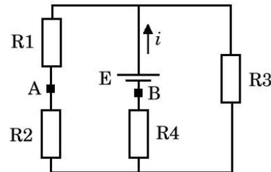
Resp.  $i_1=i_2=i_3=2A$ ,  $R_4=1\Omega$ ,  $\Delta V_{AB}=14 V$ .
