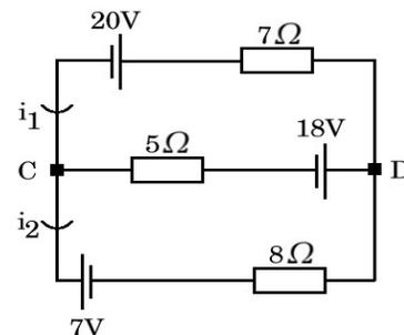
Resp.: a)  $i_1 = -1,15\text{ A}$ ,  $i_2 = -2,37\text{ A}$ , b) 11,9 V, c) 7,37W
