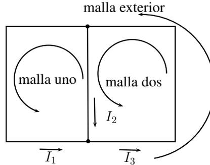
En la figura vemos una propuesta (arbitraria) para las corrientes. ¿Qué pasa si nos equivocamos con el sentido de circulación que elegimos? Nada. Si nos equivocamos de sentido, cuando hallemos la corriente nos va a dar negativo, eso nos va a indicar que debemos dar vuelta la flecha que pusimos en la figura 1.
