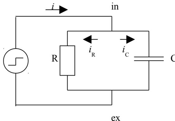
El circuito de la figura reproduce el comportamiento eléctrico de la membrana celular (dejando de lado la generación de potencial de acción). El capacitor, que representa la capacidad de la
