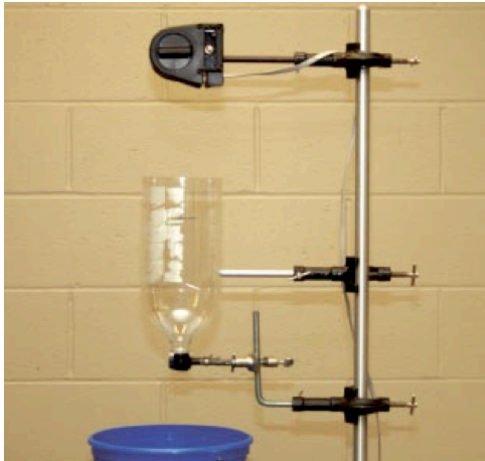
Figura 1. Esquema del montaje y de las variables asociadas. El panel de la izquierda muestra una foto del montaje, donde pueden verse (desde arriba hacia abajo) el sensor de movimiento, el recipiente de descarga y el balde para coleccionar el líquido evacuado. El panel de la derecha muestra las diferentes variables necesarias para modelar el escenario físico considerado.
