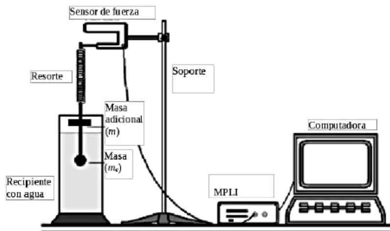
*Esquema del dispositivo a utilizar en la práctica. El recipiente con agua se emplea sólo en la segunda parte*
