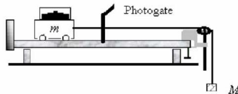
Figura 1 Esquema experimental para el estudio de la velocidad de un carro
