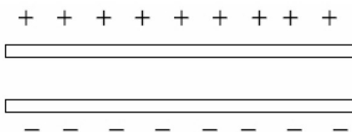
Figura 1: Esquema de un capacitor de placas paralelas.
