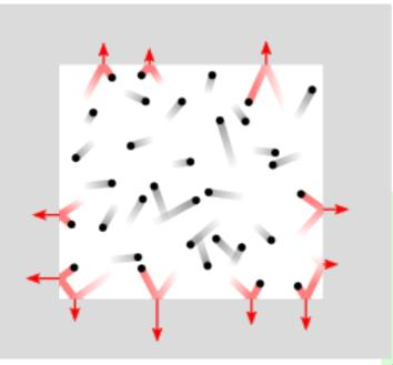
Debido a los choques de estas "partículas" sobre las paredes del recipiente que contiene al fluido, el fluido ejerce una presión sobre dichas paredes. La presión relaciona la fuerza con la superficie sobre la cual actúa.
