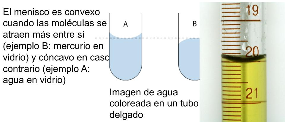
La acción de las fuerzas de cohesión entre las moléculas de un fluido y de la interacción entre ellas y las del recipiente que los contiene da lugar al fenómeno conocido como capilaridad.
