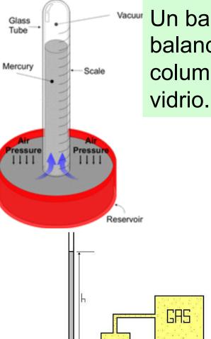
Un barómetro mide la presión atmosférica balanceándola con la presión que ejerce una columna de mercurio contenida en un tubo de
