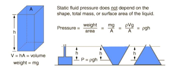
La presión en el seno de un fluido en reposo compensa el peso de la columna de fluido por encima del punto donde se mide la presión.
