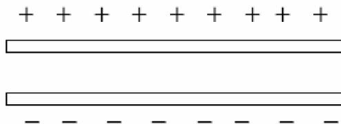
**Figura 1.** Esquema de un capacitor de placas paralelas
