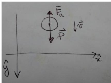
En el diagrama esquematizamos las fuerzas actuantes sobre el objeto. La segunda ley de Newton rige la dinámica de este movimiento por lo que  $\vec{P} + \vec{f}_a = m\vec{a}$
