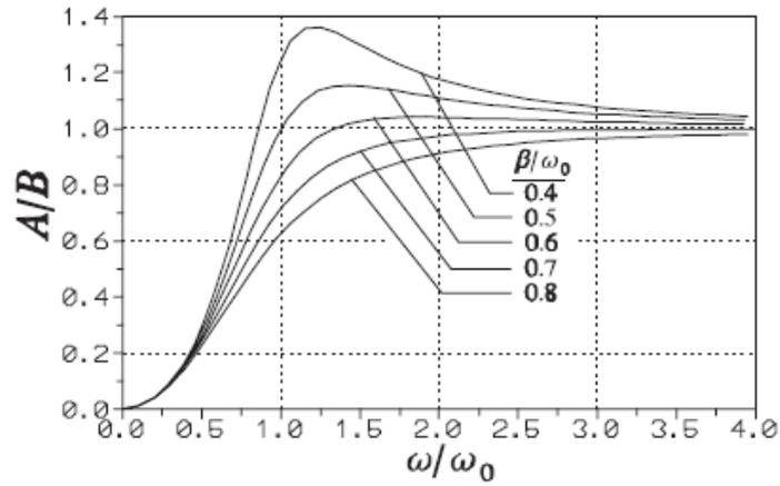
Figure 6: Curvas de resonancia para el sismógrafo en distintos valores de los parámetros
