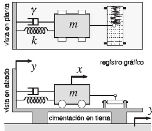
Figure 5: Esquema de un sismógrafo analógico. En este caso se trata de uno que registra las ondas S (movimientos laterales de la tierra)
