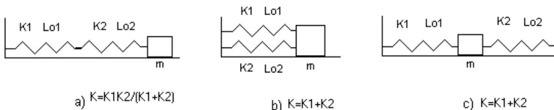
Figure 1: Esquemas con resortes
