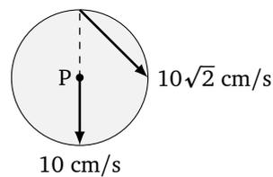
**10** Un cilindro de radio  $R = 10$  cm rueda sin resbalar sobre un plano horizontal. Su centro se desplaza con velocidad  $v_C = 10$  cm/s. Para los puntos P (en el borde), Q (a distancia  $R/2$  del centro) y A (sobre una manivela de longitud  $2R$  fija al cilindro):
