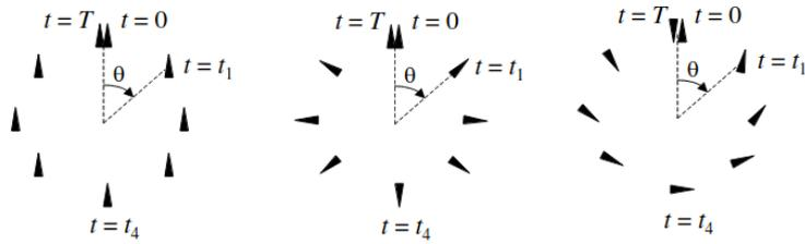
4 El centro de una esfera describe un movimiento circular uniforme de velocidad angular  $\omega$  alrededor de un punto O. Simultáneamente, la esfera gira sobre si misma, de tal forma que un punto A de la misma demora un tiempo  $\tau$  en volver a enfrentarse con el punto O.
