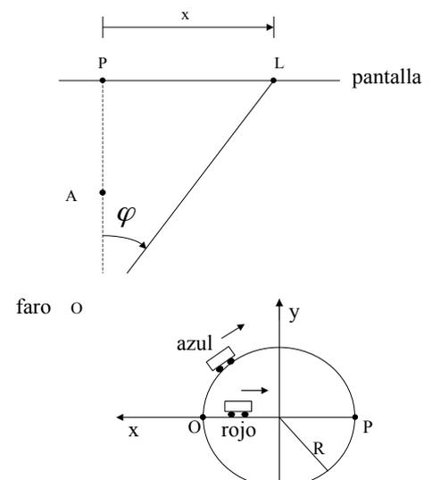
22 - Un auto azul parte del reposo desde el punto  $O$  en el instante  $t = 0$ , y describe una trayectoria circular de radio  $R = 90$  m con una aceleración angular  $\Gamma_\alpha = kt$  ( $k = \frac{\pi}{6} \text{s}^{-3}$ ). Pasado un tiempo de 3 s desde la partida del auto azul, parte del reposo desde  $O$  un auto rojo que se mueve en línea recta hacia el punto  $P$  con una aceleración constante:  $a_r = -a_0 \hat{x}$
