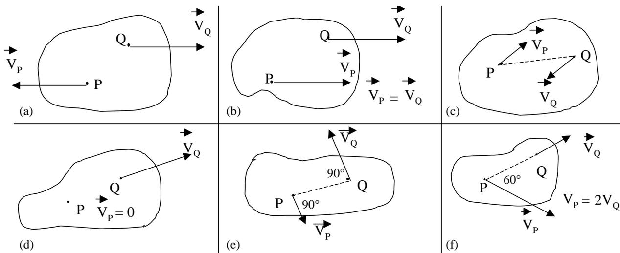
2 - ¿Qué dirección debe tener el vector  $\mathbf{v}_{PQ} = \vec{v}_P - \vec{v}_Q$  para que no cambie la distancia entre P y Q? La expresión  $\vec{v}_P - \vec{v}_Q = \vec{\Omega} \times \vec{r}_{QP}$  ¿satisface esa condición?.
