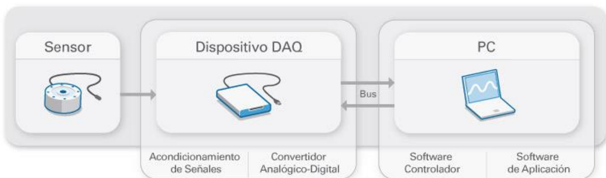
Figura 1: Partes de un sistema DAQ.
