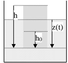
14) Se tiene una pelota de ping-pong dentro de un tubo lleno de agua, como se muestra en la figura. Si el tubo rota alrededor del eje con velocidad angular  $\omega$ , ¿qué posición ocupa la pelota? ¿Y si la pelota fuese de aluminio? Justifique su respuesta.
